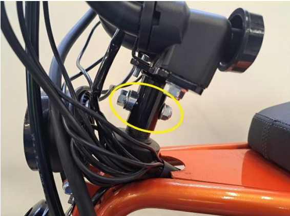
Irrota ohjaustangon kiinnikkeen kiinnityspultti (kiintoavain 2 kpl 14 mm).
