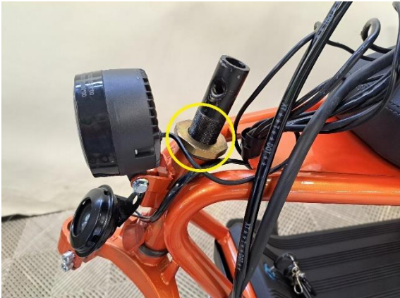
Irrota ohjauslaakereiden kiristysmutteri (kiintoavain 45 mm).
