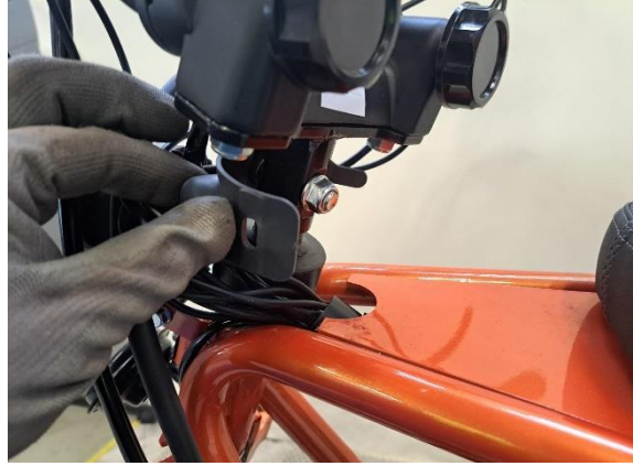
Irrota ohjaustangon kiinnikkeen kiinnityspultin suoja.
