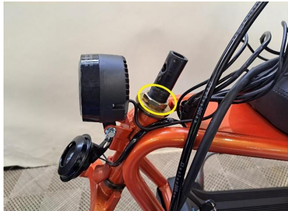
Irrota ohjauslaakereiden lukitusmutteri (kiintoavain 32 mm).
